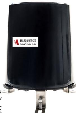
MR400-04雨量感測器是一種水文氣象測量儀器，用於測量降雨量，並將降雨量轉換為脈衝信號輸出。採用防蟲網設計，防止堵塞噴嘴，內置水準泡。該感測器可用於氣象、水文、農業、林業、野外監測站等行業。配合資料記錄儀可對降雨、降雨強度、降雨時長進行測量。
